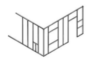
Каркас для крепления стеновых панелей типа «сэндвич» представляет собой пространственную конструкцию из опорных профилей, вертикальных стоек, горизонтальных промежуточных ригелей, погонов и балок с ЛКП.
