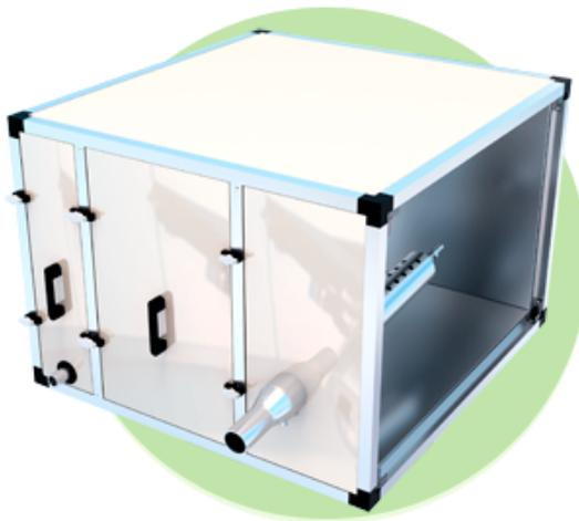
**Сливной патрубок** может быть выведен на сторону обслуживания или снизу корпуса. Блок может быть укомплектован **сифоном с гидрозатвором или обратным клапаном**. Со стороны обслуживания предусмотрена **съёмная инспекционная панель**.
